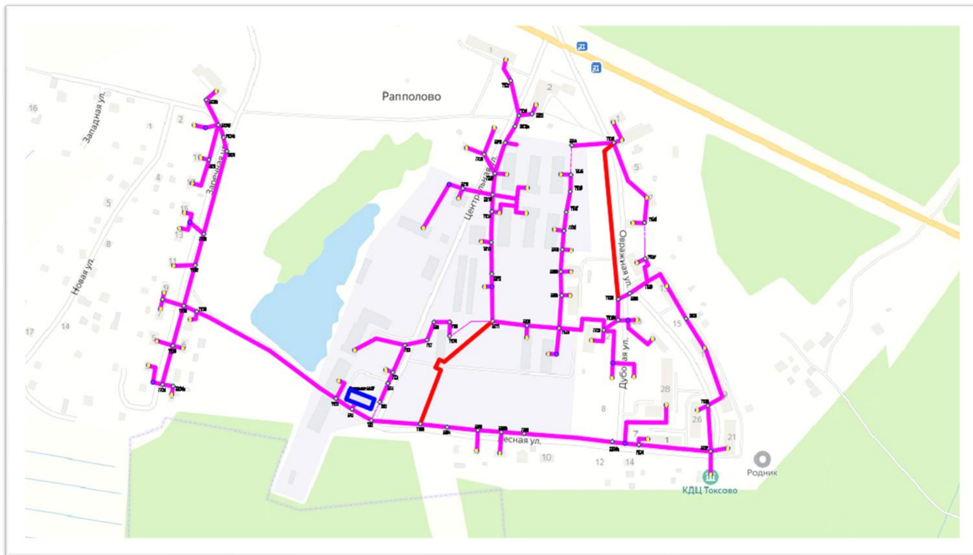
Рис.2.5. Схема тепловых сетей котельной № 31
